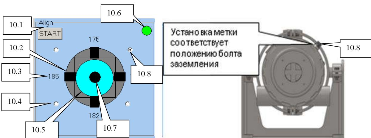
На панели отображаются данные о положении пятна ИК излучения относительно оптической оси прибора.
