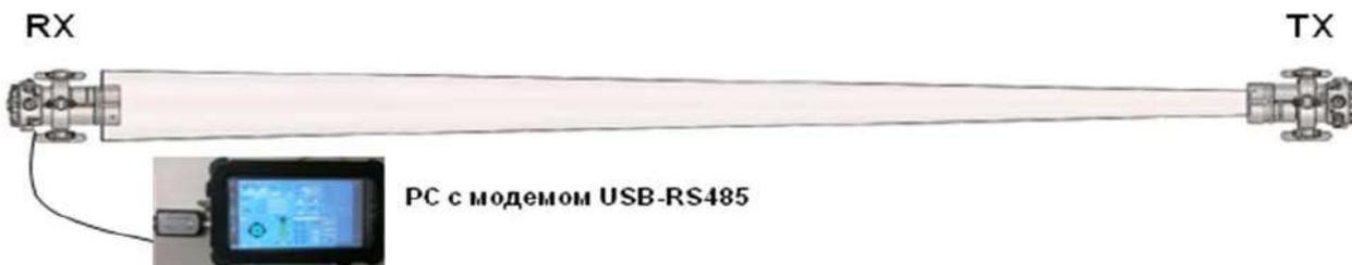
Перед проведением установки нуля и калибровки газоанализатора необходимо убедиться (с помощью переносного газоизмерительного прибора / газосигнализатора) в отсутствии загазованности на всем протяжении измерительной трассы между модулями ТГАЭС и отсутствии всяких препятствий, прекрывающих луч.
