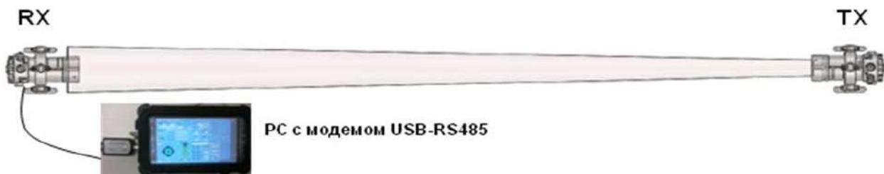
Перед проведением установки нуля и калибровки газоанализатора необходимо убедиться (с помощью переносного газоизмерительного прибора / газосигнализатора) в отсутствии загазованности на всем протяжении измерительной трассы между модулями ТГАЭС и отсутствии всяких препятствий, перекрывающих луч.
